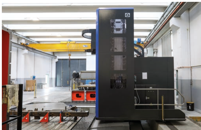
A sinistra: la fresatrice a montante mobile Soraluce modello FP 10.000 si dimostra una soluzione multitasking e multifunzionale
